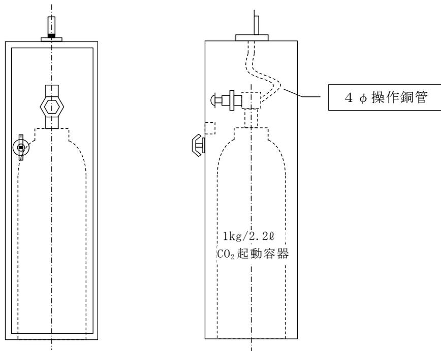
資料 2 二酸化炭素消火設備全域放出方式図・放出表示灯の設置例
