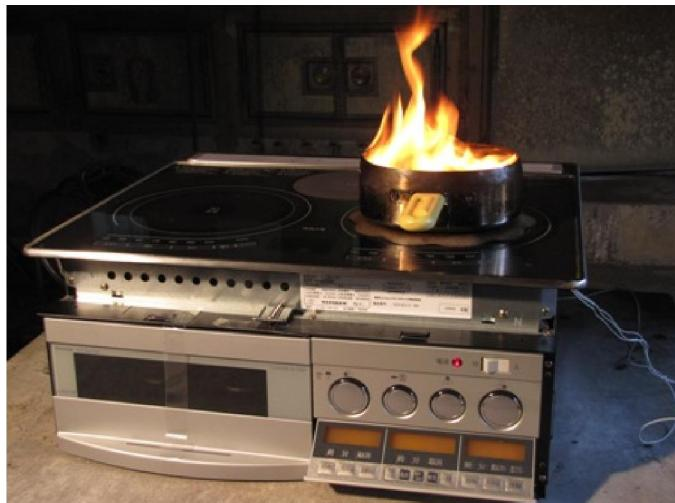
IHクッキングヒーターは、直接火を使用しない上、一定の温度以上になると温度センサーにより自動的に加熱を停止する「安全装置」がついているため、安全性が高いと言われています。
