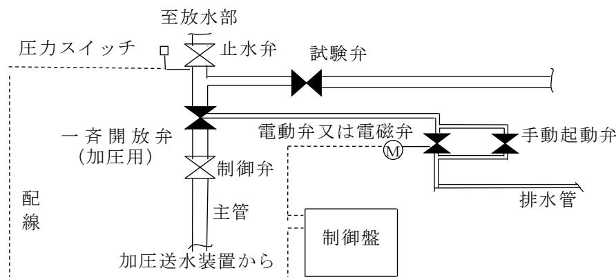
第4-13図（加圧方式の一斉開放弁等の廻りの配管図例）
