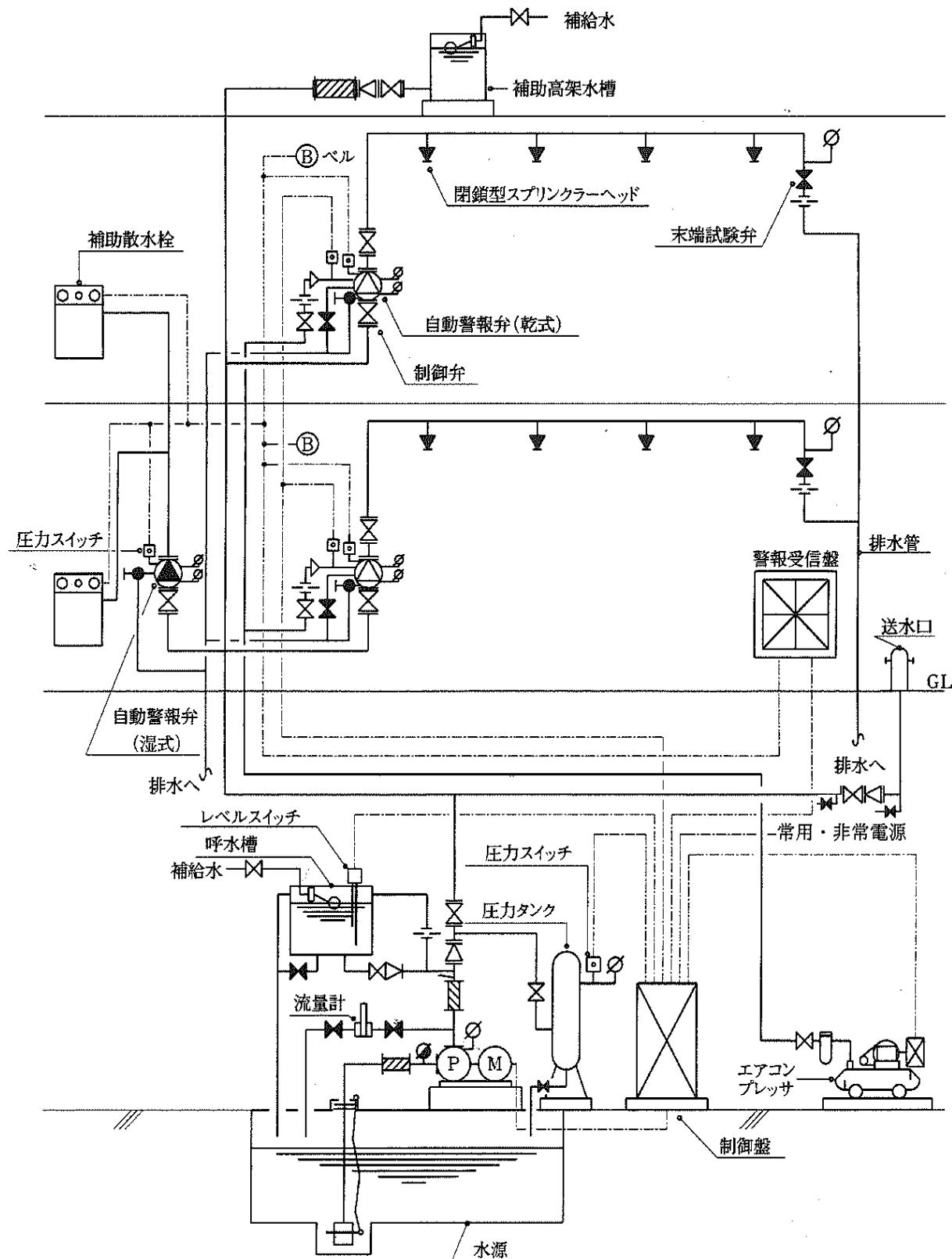
※ 補助高架水槽直近の配管に設けるフレキについては、止水弁の1次側、2次側のいずれでも可とする。
