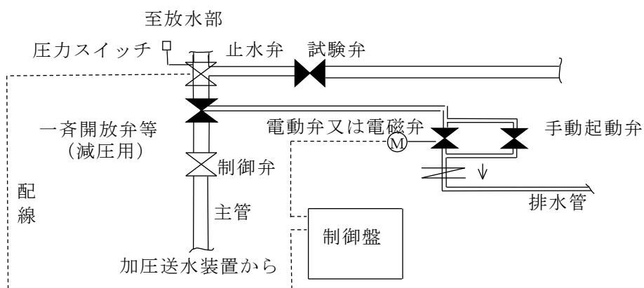
第4-12図（減圧方式の一斉開放弁等の廻りの配管図例）
