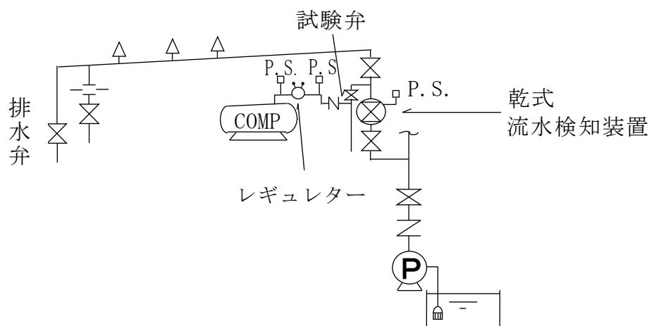
第4-27図（乾式流水検知装置）
