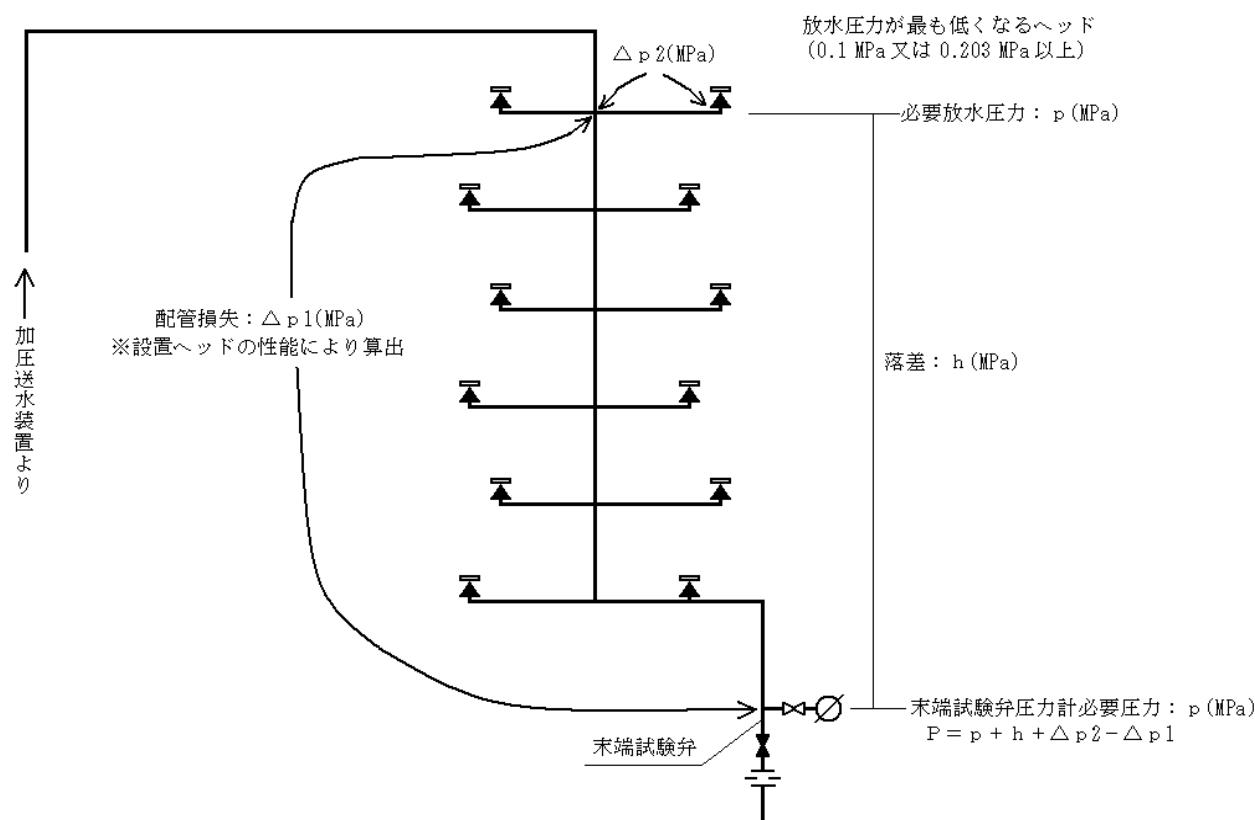
注 0.203 MPa は、ヘッドの呼び径が 15 のスプリンクラーヘッドを用いた場合の放水圧力を示す。
