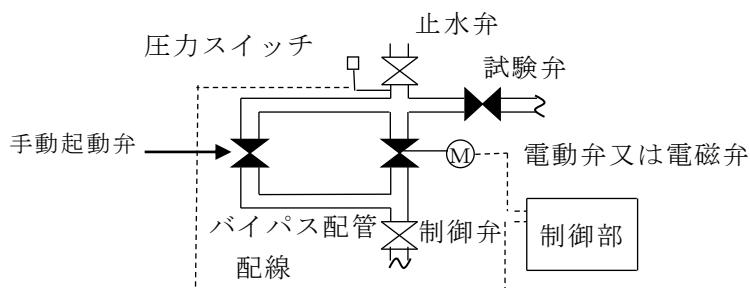
第4-14図（電動又は電磁弁方式の廻りの配管図例）
