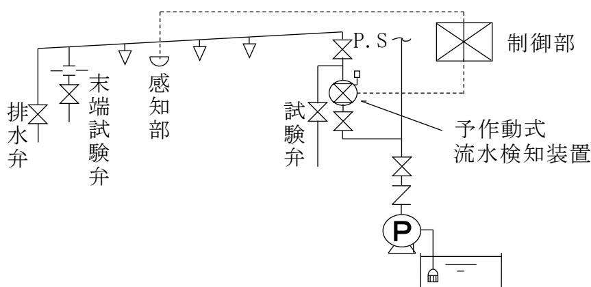
第4-26図（予作動式流水検知装置）
