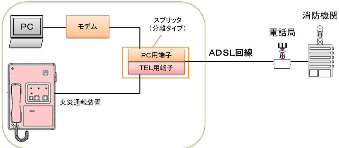
第14-8図 ADSL回線に接続する火災通報装置の概要図
