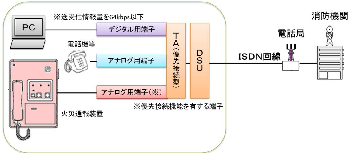
第 14-9 図 ISDN回線に接続する火災通報装置の概要図
