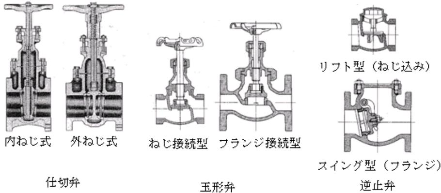
カ 管継手及びバルブ類は、設置箇所の使用圧力値以上の圧力値に適合するものを設けること。☞ ii
