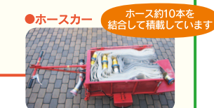
●ホースカー ホース約10本を結合して積載しています
