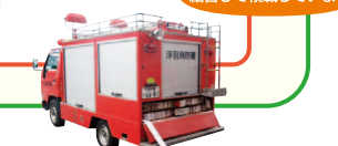
●ホースカー ホース約10本を結合して積載しています
